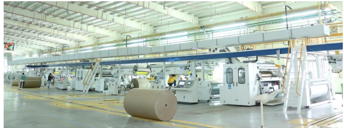
1.8 米瓦楞纸板生产线 1台
