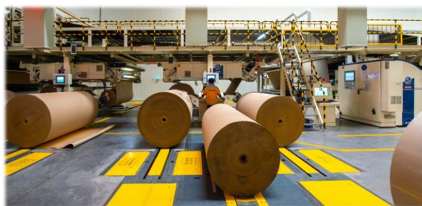
自动原纸物流系统 (一键上纸/自动回纸)
